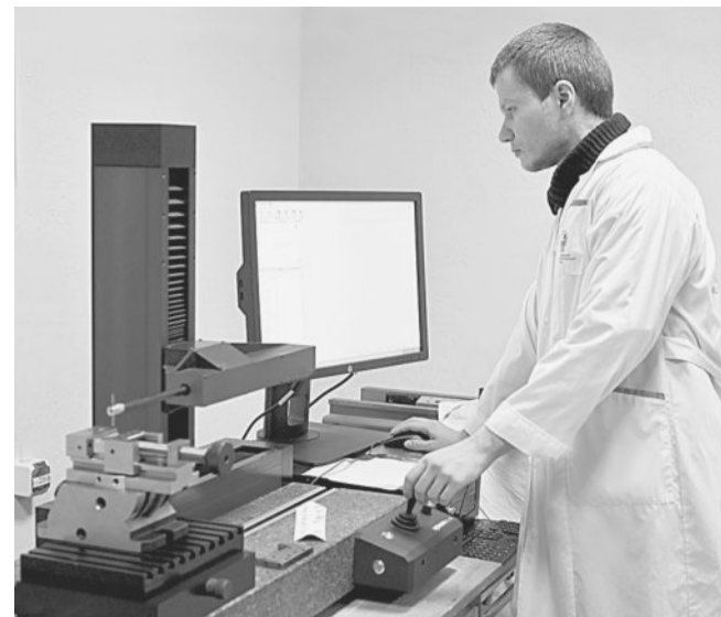
БЫСТРО, НАДЁЖНО, ТОЧНО! Роман Пантелеев работает на универсальной измерительной установке.
